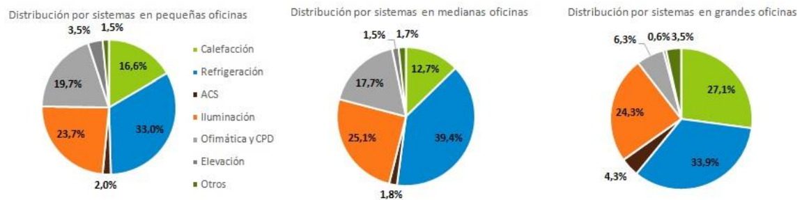
Figura 1. Distribución por sistemas de edificios con las distintas tipologías de oficinas en zona climática C4. (Letter Ingenieros)
